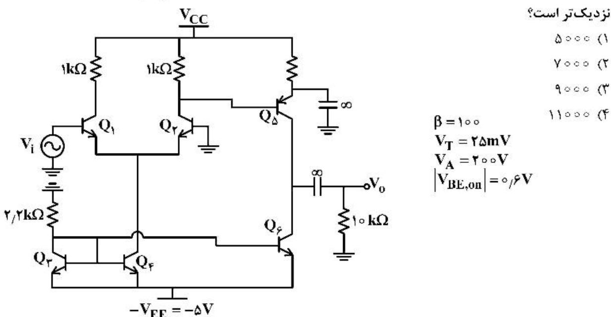
۱۲۶- در مدار زیر، اندازه  $\frac{V_0}{V_s}$  به کدام گزینه نزدیک‌تر است؟ ترانزیستورها دارای پارامترهای سیگنال کوچک مشابه
