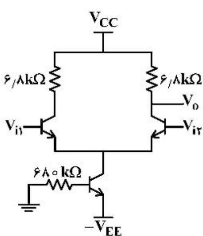
۱۲۵- در شکل زیر، ترانزیستورها یکسان هستند و در ناحیه فعال قرار دارند. مقدار به کدام گزینه نزدیک‌تر است؟
