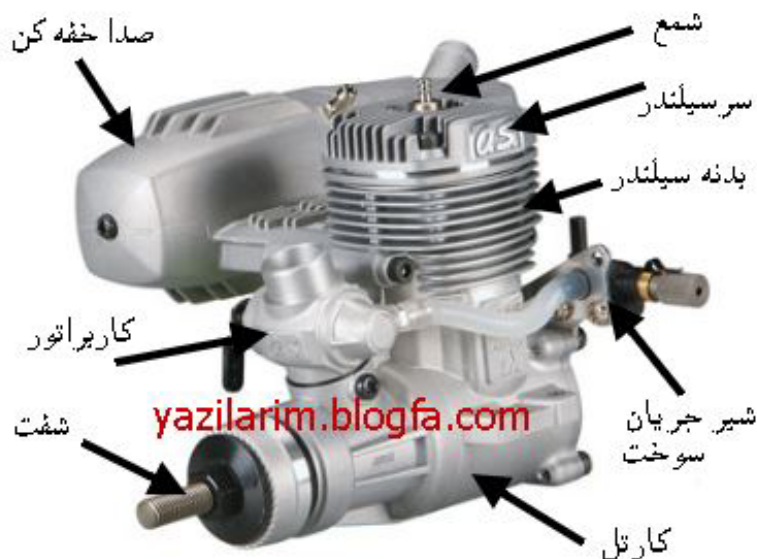
بخشهای مختلف یک موتور دو زمانه
