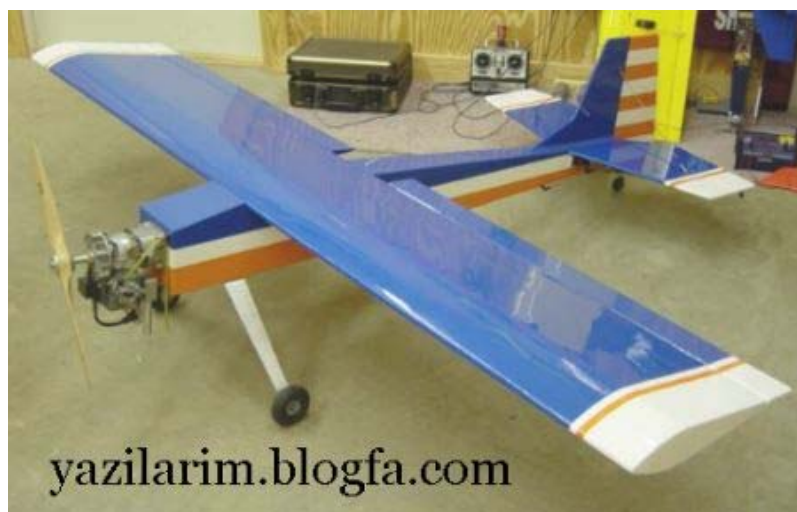
هواپیمای مدل مجهز به چرخ فرود دم
