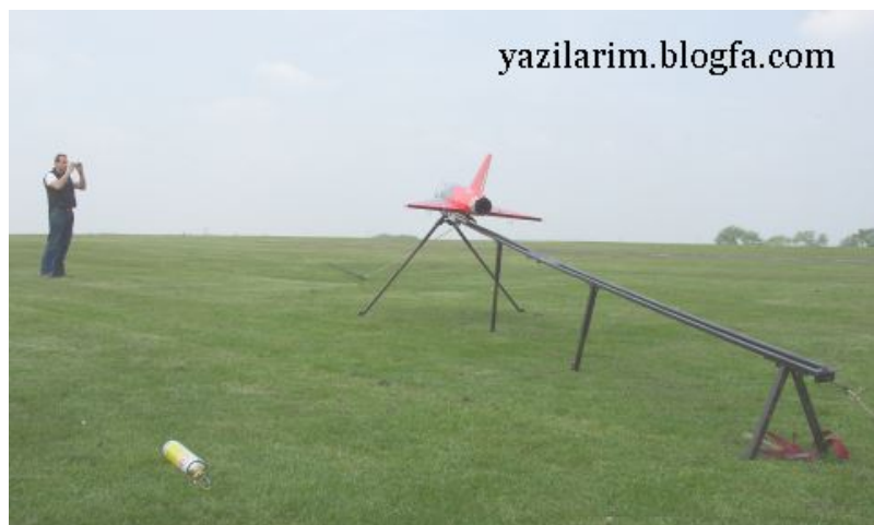
پرتابگر پنوماتیکی برای یک نوع هواپیمای مدل جت
